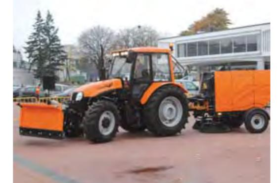
ZEFIR 85K со снегоотвалом PUV-2800 и подметальной машиной ZMC 2.0
