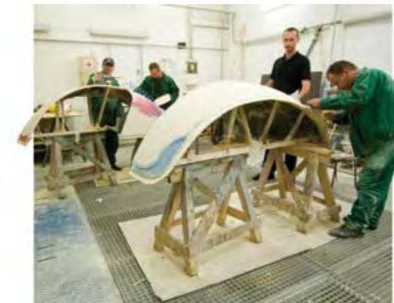
Изготовление модели задних грязевиков тракторов PRONAR P6 и P9 для создания производственной формы
