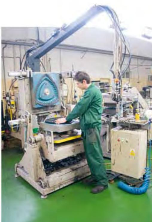
Место для изготовления детали методом выпрыска под низким давлением таких элементов как: подлокотники, подголовники, ручки, рулевые колёса
