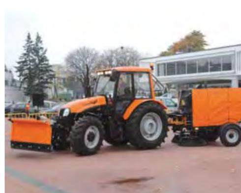
ZEFIR 85K со снегоотвалом PUV-2800 и подметальной машиной ZMC 2.0
