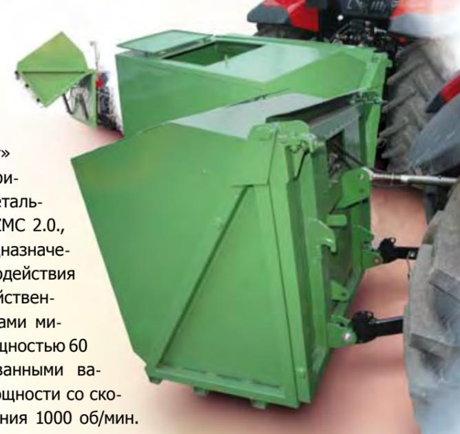
Самозагружаемый контейнер (грузоподъёмность 1000 кг, вместительность 1,5м³) крепится на задней или передней трёхточечной навеске TУЗ трактора или на фронтальном погрузчике
