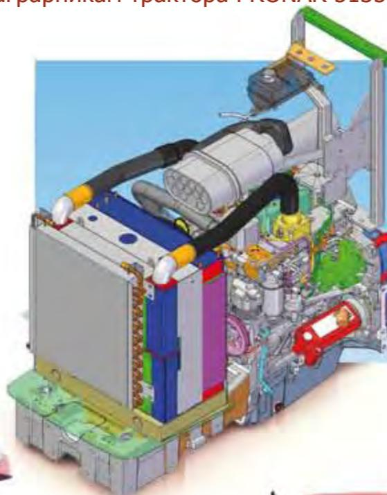
Двигатель IVECO Tier IIIA
