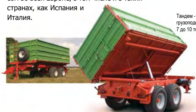
Тандем - прицепы грузоподъёмностью от 7 до 10 тонн
