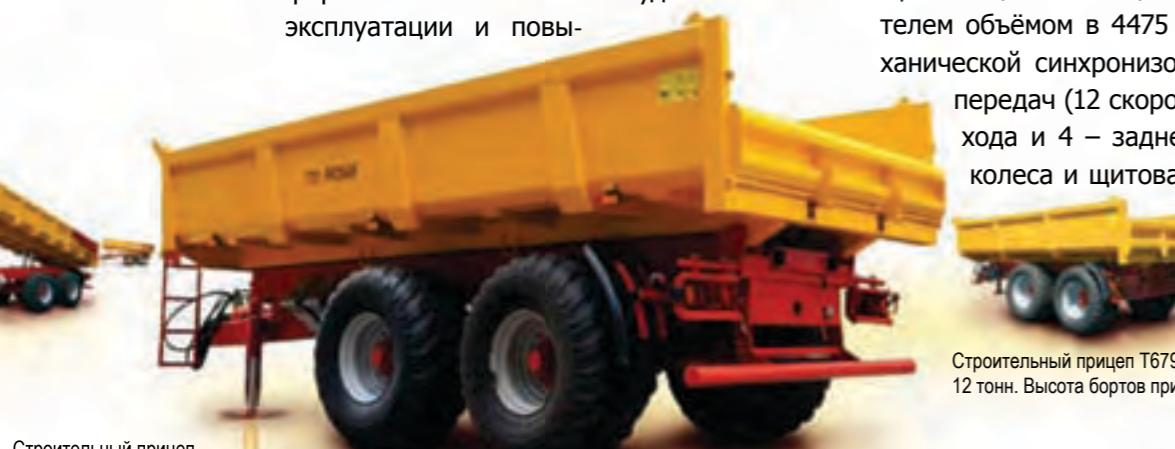
Строительный прицеп T701 - грузоподъёмность 18 тонн. Высота бортов прицепа 800 мм
