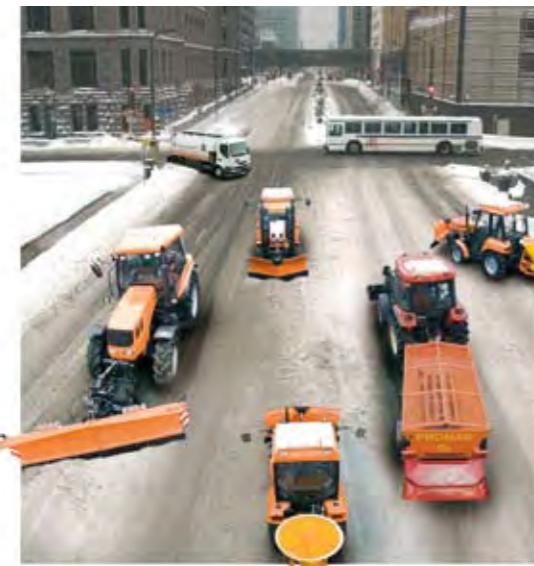
Отвалы PU-2600 и PU-3300 подвешиваются на трёхточечную систему подвески II или III категории ISO и агрегатируются с тракторами мощностью от 80 л.с. до 150 л.с.
