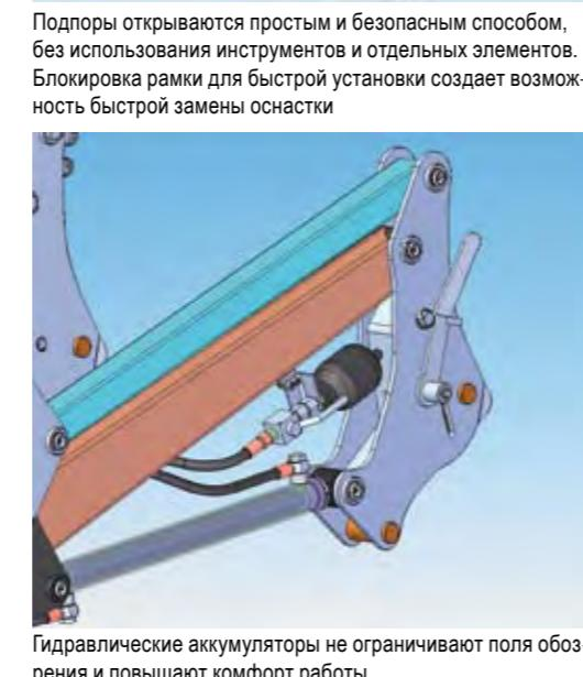
Подпоры открываются простым и безопасным способом, без использования инструментов и отдельных элементов. Блокировка рамки для быстрой установки создает возможность быстрой замены оснастки
