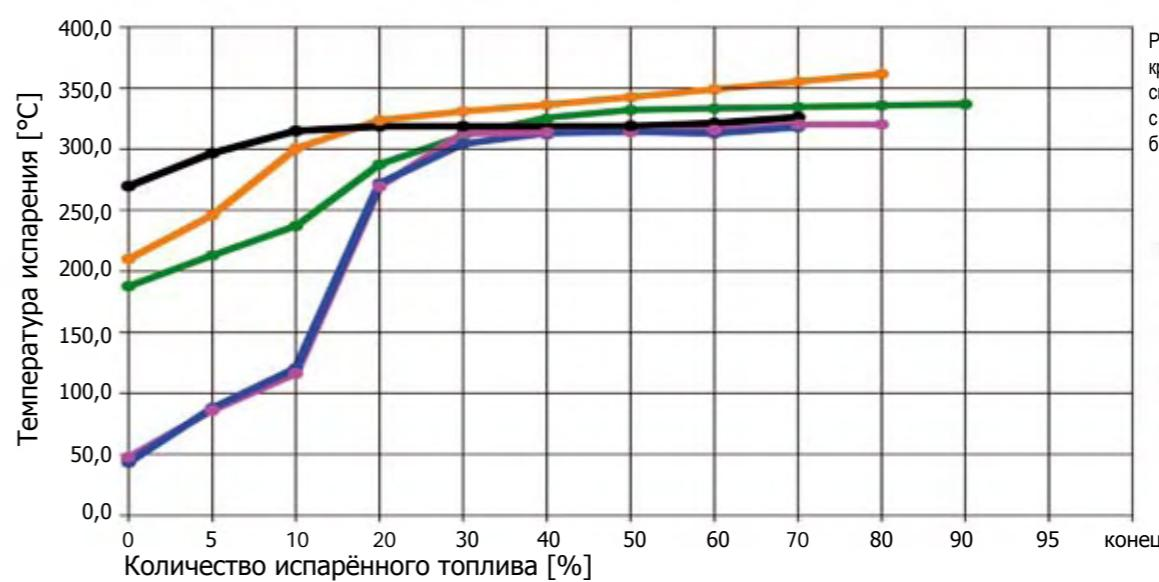
Рисунок 2. изменения кривой фракционирования смеси рапсового масла с дизельным топливом и бензином
