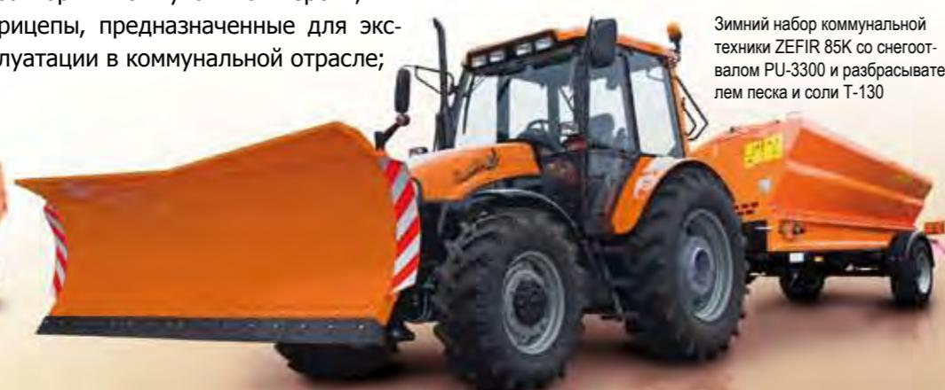
Зимний набор коммунальной техники ZEFIR 85K со снегоотвалом PU-3300 и разбрасывателем песка и соли T-130
