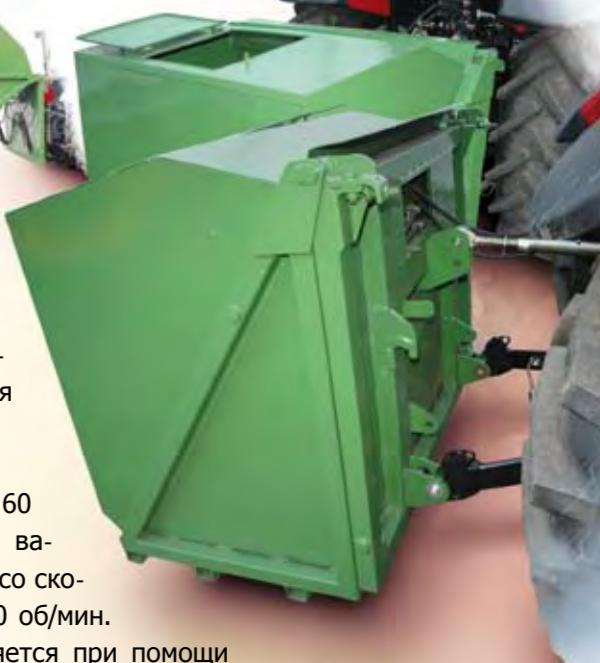
Самозагрузочный контейнер (грузоподъёмность 1000 кг, вместимость 1,5м<sup>3</sup>) крепится на задней или передней трёхточечной навеске TUZ трактора или на фронтальном погрузчике
