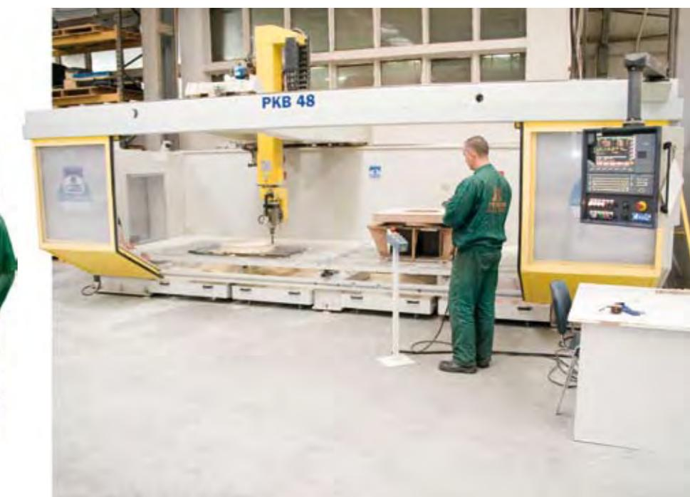
Фрезерный станок CNC перед запуском
