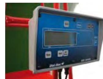
Весы с дисплеем в смесителе-кормораздатчике позволяет установить точную дозировку компонентов корма
