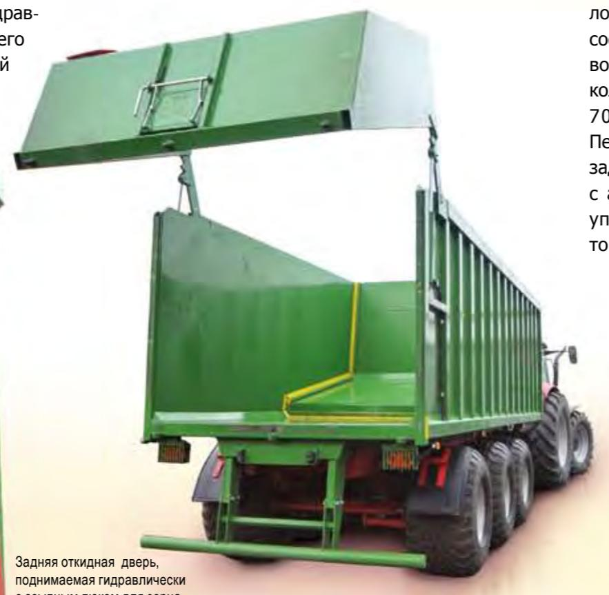
Задняя откидная дверь, поднимаемая гидравлически с ссыпным люком для зерна
