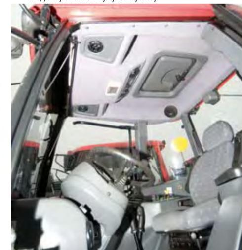
Подшивной потолок замонтирован в тракторе серии PRONAR P5 вместе с добавочными элементами и является эргономически и комфортабельно запроектированным элементом интерьера в кабине
