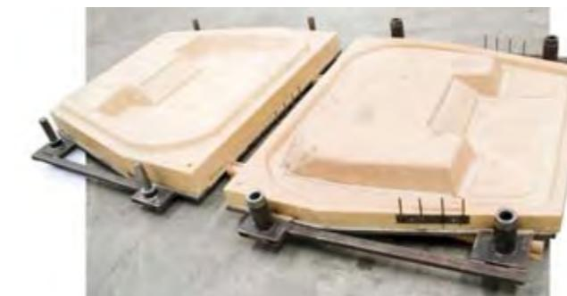
Две половинки формы обшивки, подготовленные для производства элементов под пресс-формированием
