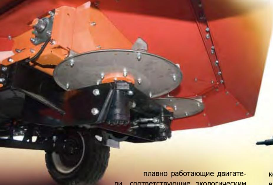
T130 – это машина с двумя разбрасывающими щитами, ленточным конвейером с плавной регулировкой перемещения. Рабочая ширина разбрасывателя составляет 1,5-5 метров, загрузочная ёмкость – 2м³, а допустимая грузоподъёмность – 2,5 тонны
