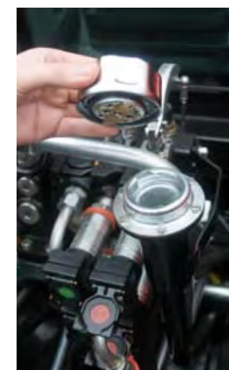
Легкий доступ к пробке маслоналивной горловины в значительной степени облегчает техническое обслуживание трактора
