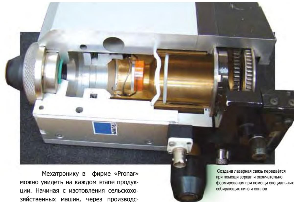
Создана лазерная связь передаётся при помощи зеркал и окончательно сформирована при помощи специальных собирающих линз и соплов
