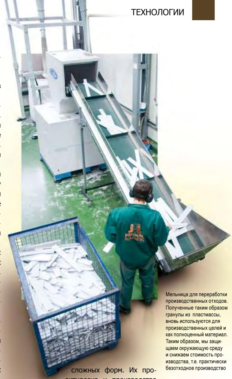
Мельница для переработки производственных отходов. Полученные таким образом гранулы из пластмассы, вновь используются для производственных целей и как полноценный материал. Таким образом, мы защищаем окружающую среду и снижаем стоимость производства, т.е. практически безотходное производство
