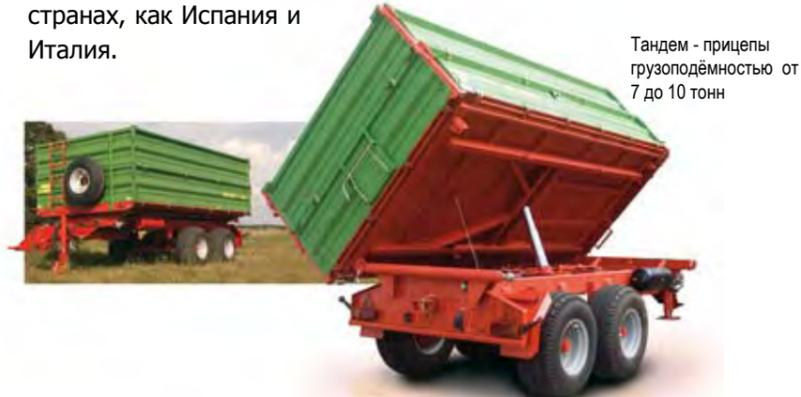
Тандем - прицепы грузоподъёмностью от 7 до 10 тонн
