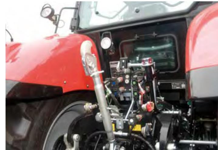
Маслоналивная горловина для трансмиссионного масла в тракторах PRONAR 8140, сконструированная на приводной системе ZF находится в задней части трактора
