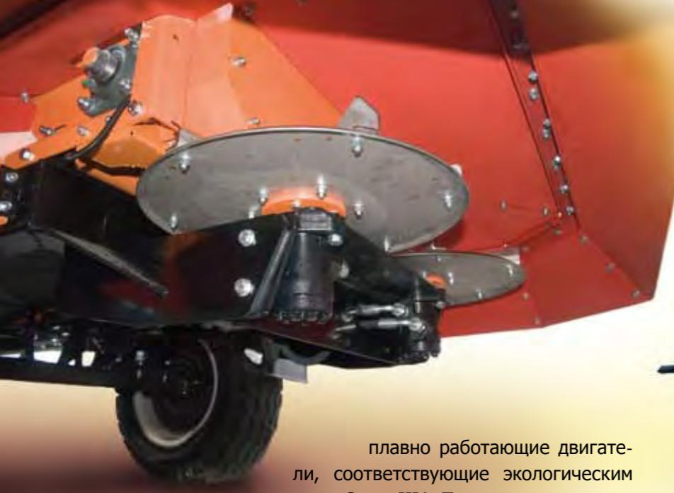
T130 – это машина с двумя разбрасывающими щитами, ленточным конвейером с плавной регуляцией передвижения. Рабочая ширина разбрасывателя составляет 1,5-5 метров, загрузочная ёмкость – 2м<sup>3</sup>, а допустимая грузоподъёмность – 2,5 тонны
