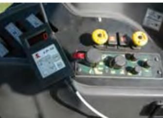
Панель управления прессом, расположенная в кабине трактора, облегчает работу оператора
