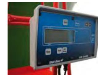
Весы с дисплеем в смесителе-кормораздатчике позволяют установить точную дозировку компонентов корма
