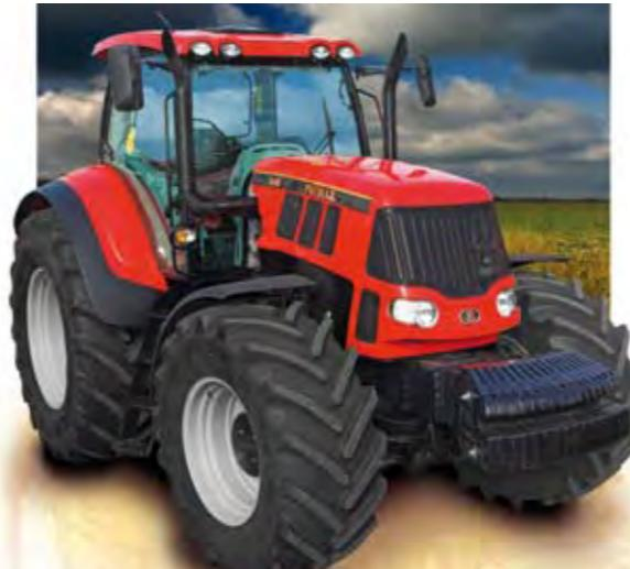
Для конструкции тягачей самой большой мощности были использованы самые современные запчасти мировых магнатов отрасли – двигатель Deutz, оси ZF и Dana, электрогидравлическая система Bosch
