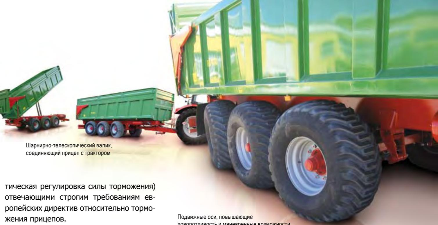
Шарнирно-телескопический валик, соединяющий прицеп с трактором
