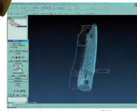
Формирование фрезерной модели в модуле CAM
