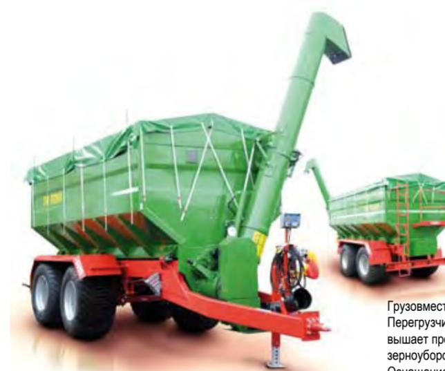
Грузоместимость бункера Перегрузчика Т740 28м<sup>3</sup> повышает производительность зерноуборочного комбайна. Оснащение Перегрузчика лестницей и смотровой площадкой улучшает обслуживание тента и даёт возможность пользователю следить за состоянием содержимого зерна при погрузочно-разгрузочных работах
