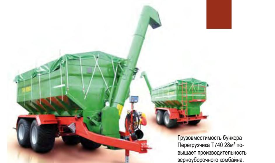
Грузовместимость бункера Перегрузчика Т740 28м<sup>3</sup> повышает производительность зерноуборочного комбайна. Оснащение Перегрузчика лестницей и смотровой площадкой улучшает обслуживание тента и даёт возможность пользователю следить за состоянием содержимого зерна при погрузочно-разгрузочных работах
