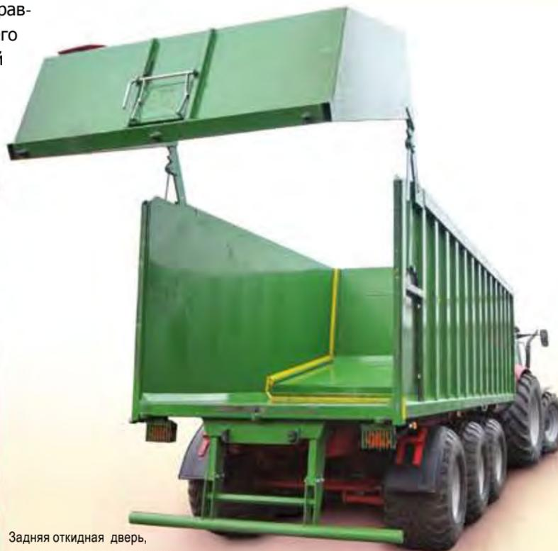
Задняя откидная дверь, поднимаемая гидравлически с сыпным люком для зерна
